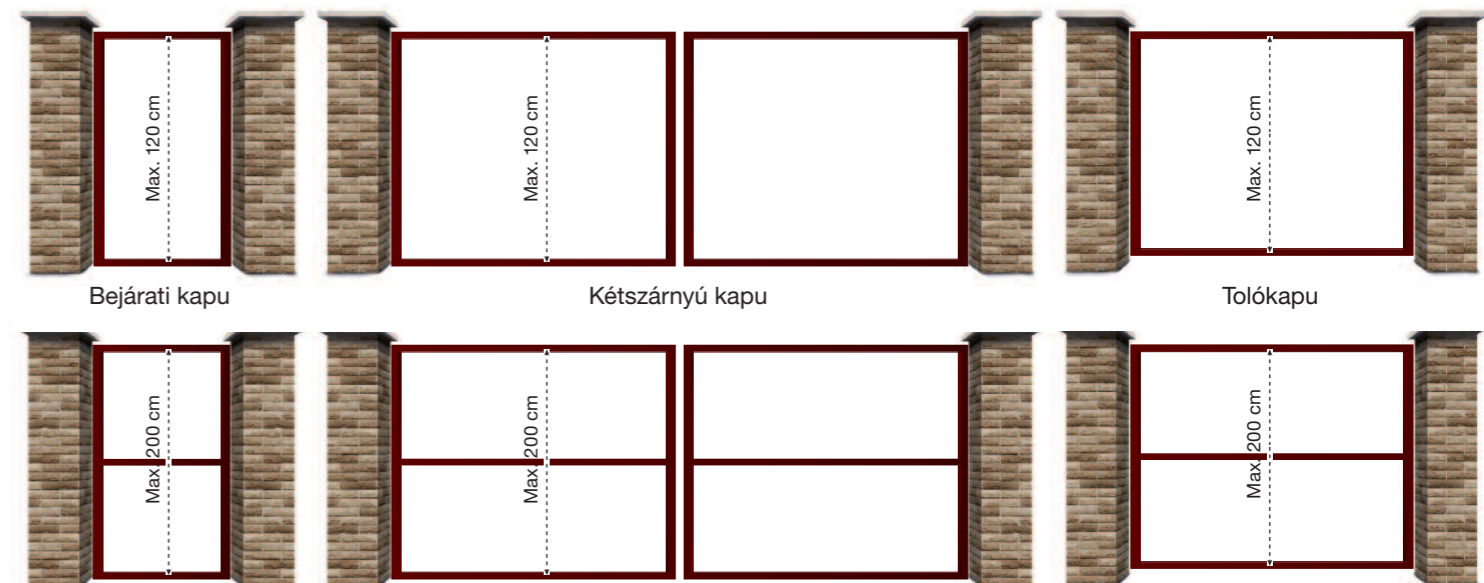
Kapuszerkezet előkészítése függőleges kerítéselemek fogadására
